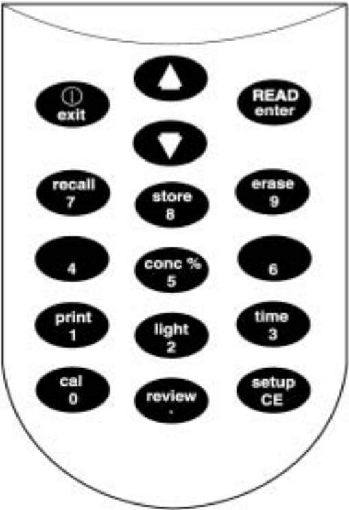
图 2 sension8 溶解氧仪的键盘
